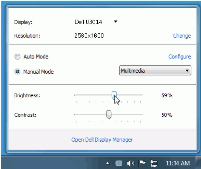
El cuadro de diálogo de configuración rápida también ofrece acceso a la interfaz avanzada de usuario de Dell Display Manager, la cual se utiliza para ajustar funciones básicas, configurar el Modo automático y acceder a otras funciones.
